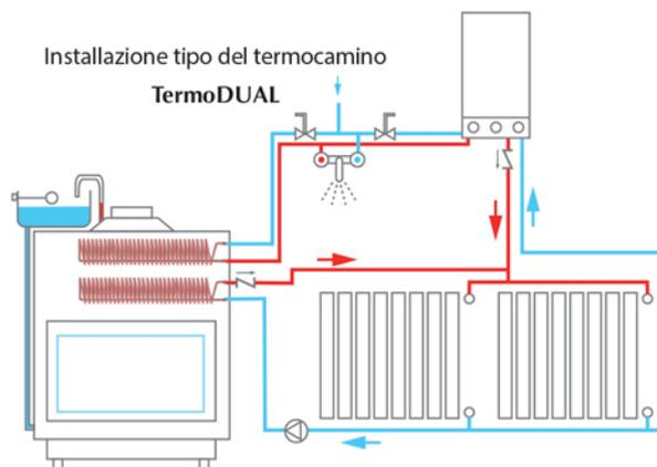
Gli esempi rappresentano solo la più semplice installazione di ognuna delle due versioni del termocamino. Esistono ovviamente svariate tipologie di installazione in funzione del caso specifico e delle tipologie e quantità di ulteriori generatori di calore presenti nell'abitazione.
